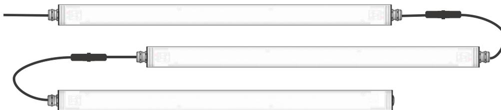
La longueur de chainage maximum, câble inclus, ne doit pas dépasser 100 m.
