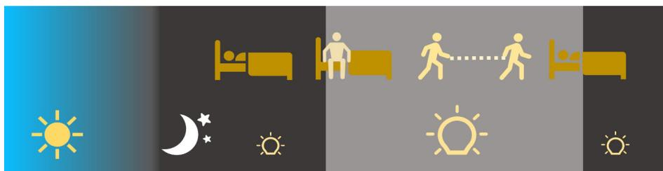
Fonctionnement du mode détection de mouvement
