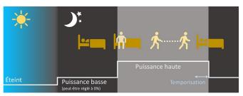
Allumé lorsque l'éclairage ambiant est inférieur au seuil crépusculaire, en puissance basse lorsqu'il n'y a pas de mouvement et en puissance haute lors d'une détection de mouvement. Lorsque la détection de mouvement disparait, la veilleuse reste en niveau haut pendant la durée de temporisation.
