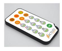
Télécommande infrarouge de configuration pour réglage des paramètres de la veilleuse.
