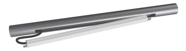
L'ACTiTube24 est un luminaire à LED qui s'intègre dans une main courante de section ronde ou carrée. Disponible en longueur de 500<sup>1</sup> mm et deux niveaux de puissance, ce luminaire est chainé par câblage traversant.
