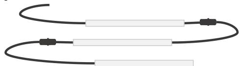
La puissance totale d'une ligne de tubulaires chainés, ne doit pas dépasser 700W. La longueur de chainage maximum, câble inclus, ne doit pas dépasser 125 m pour la version forte puissance ou 200 m pour la version faible puissance.
